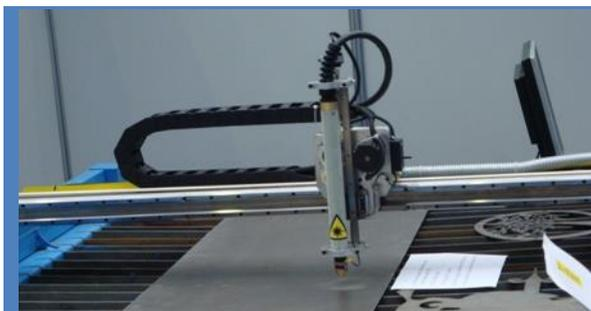
**Большим плюсом является наличие синхронизированного привода портала. Это исключает перекосы порталной конструкции, повышает надежность и скорость перемещений.**
