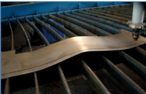
**Принцип работы контроля высоты основан на измерении напряжения дуги плазматрона при его работе. В связи с этим нет необходимости в установке на резак дополнительных неудобных тарелок и внешних навесок.**
