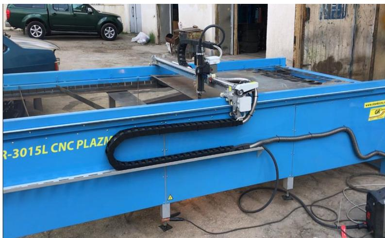
Предназначена для качественного плазменного раскроя листового металла с рабочей зоной 3050 x 1530 мм, толщиной до 0.5 до 20 мм. Доп комплектации см ниже.
